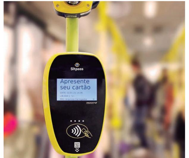
ria é realizada por meio de um conjunto de softwares, validador, câmera de altíssima resolução e avanço tecnológico, que captura fotos do cliente no momento da validação do produto Sitpass no ônibus, terminal ou estação. Posteriormente, o sistema compara as fotos de quem utilizou o serviço com a foto armazenada no seu cadastro. Caso as fotos não coincidam, evidencia-se assim o uso indevido do benefício e o cartão é auto-
