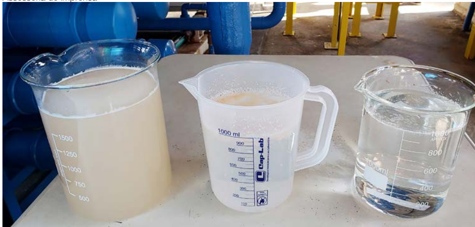
Sistema de tratamento da água por flotação assegura eficiência em purificação superior a 90%
